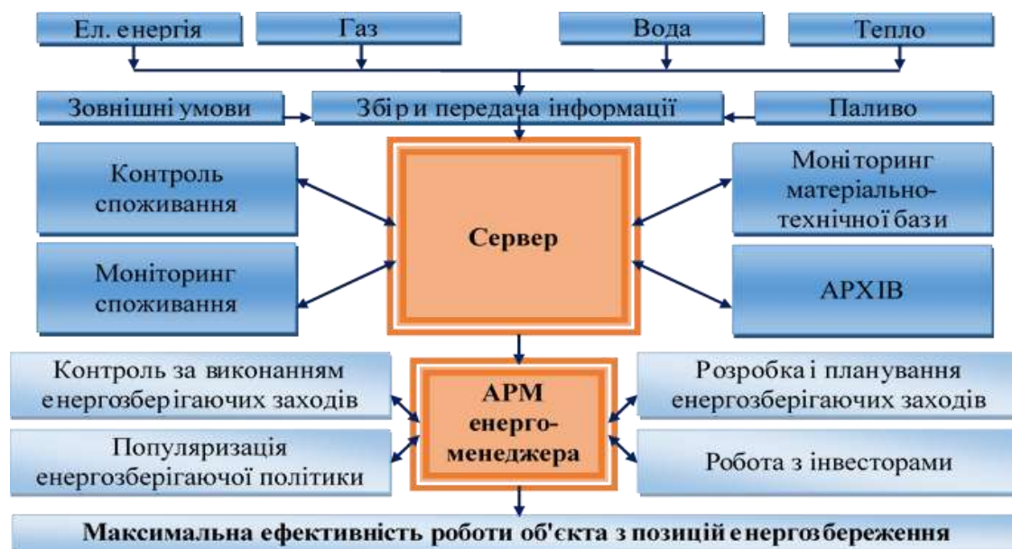
Рисунок 1. Автоматизоване робоче місце (АРМ) енергоменеджера
